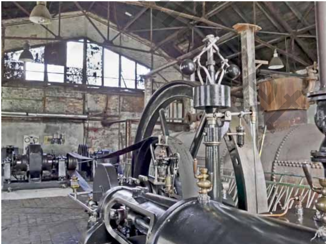
Watt'scher Fliehkraftregler, Zeichnung nach Bernoulli 1877 und an der Dampfmaschine in Ostrava Dul Michal/ CZ 2020
