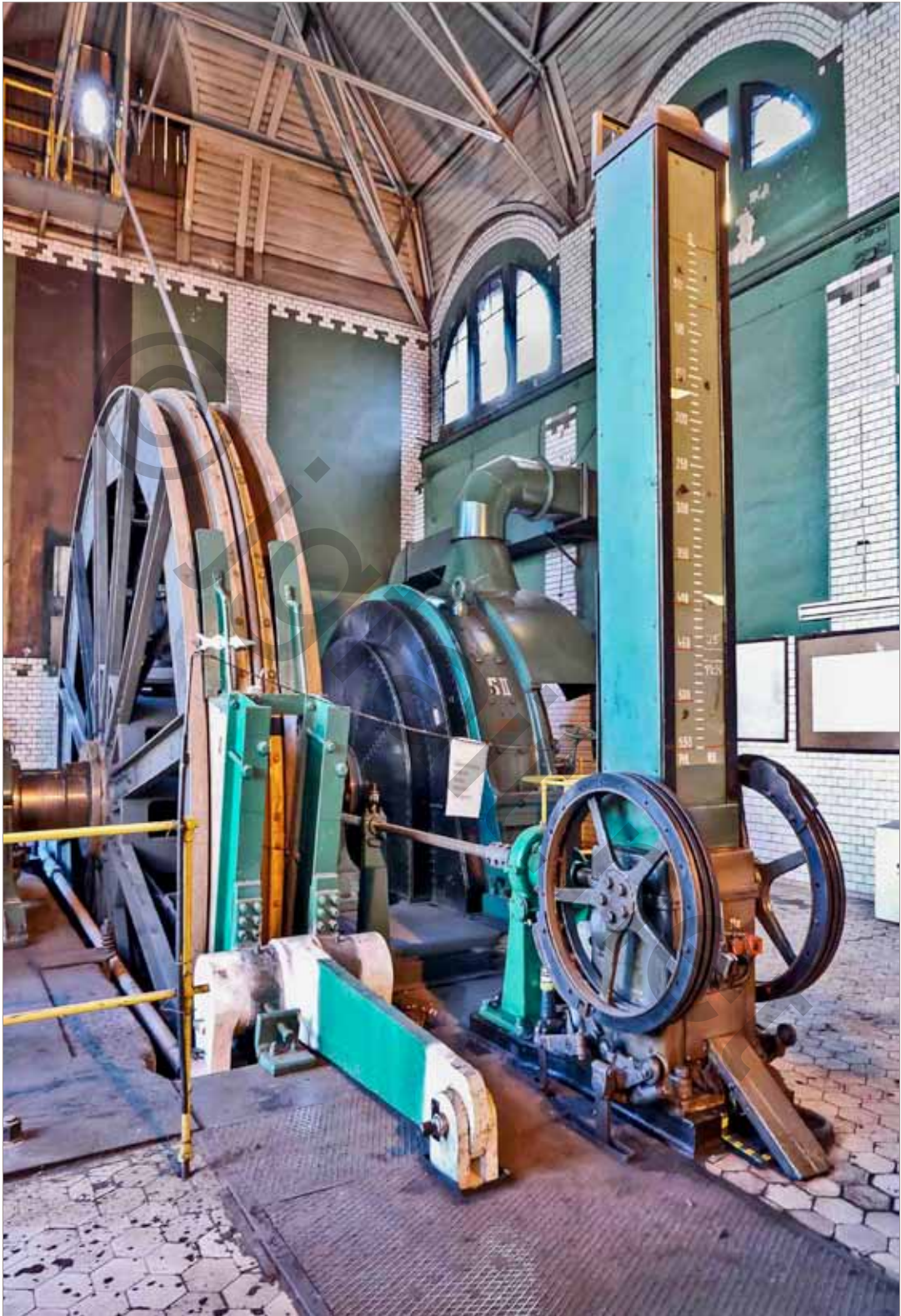
Antriebsrad und Teufenzeiger, Szyb Pulaski/ PL 2019
